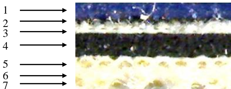
Рисунок 2 – Структура РТК. Слои композита: 1–резина; 2,6 – эластичный резиновый клей; 3, 6, 7 – х/б ткани; 4 – пенорезина
